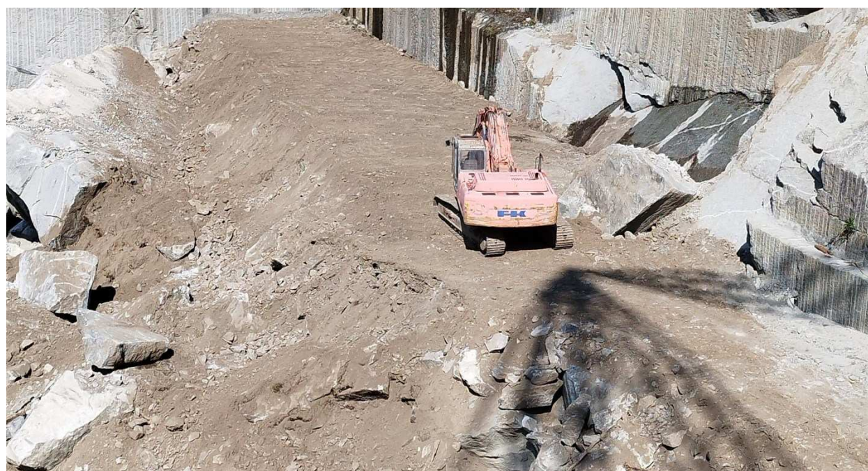
FOTO N. 6/7 – RIPRESE DA OVEST E DA EST DEL GRADONE REALIZZATO CON IL LIVELLAMENTO DEL DETRITO FINE ALLA BASE DELLA PARETE DEL FRONTE NORD. IL GRADONE IN TERRA PRESENTA UNA LARGHEZZA VARIABILE DA 8÷10 M CIRCA
